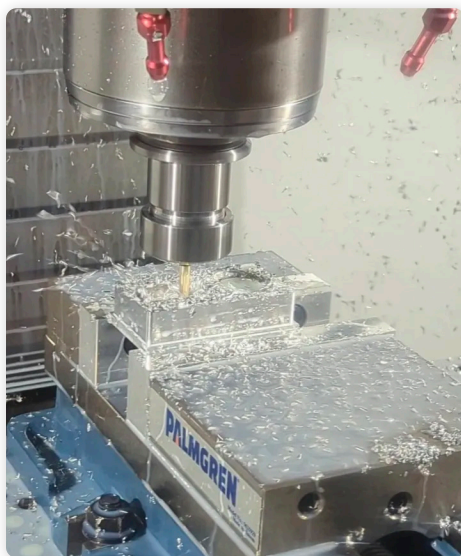
CNC milling a bracket on a Haas VF4
